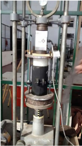
Figura 1. Compresión en prensa
