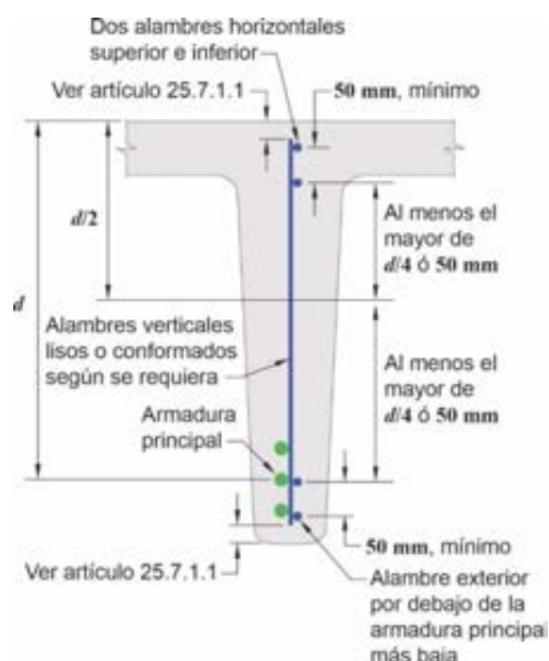
Figura C 25.7.1.5. Anclaje de la armadura a corte formada por una rama de la malla de acero soldada de alambre.
