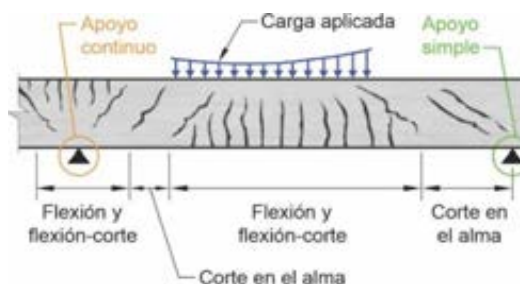
Figura C 22.5.6.3. Tipos de fisuración en vigas de hormigón.
