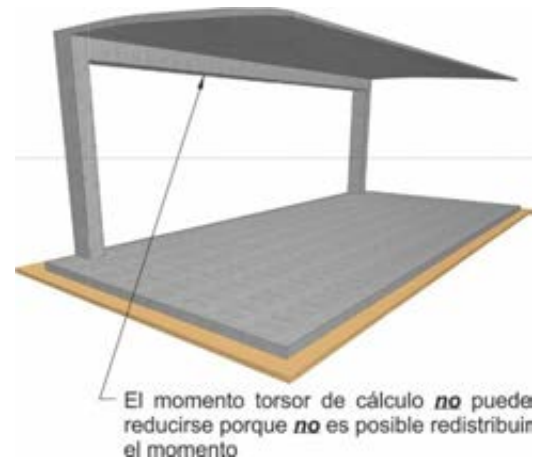
Figura C 22.7.3a. Torsión de equilibrio, el momento torsor de cálculo no puede ser reducido (artículo 22.7.3.1).
