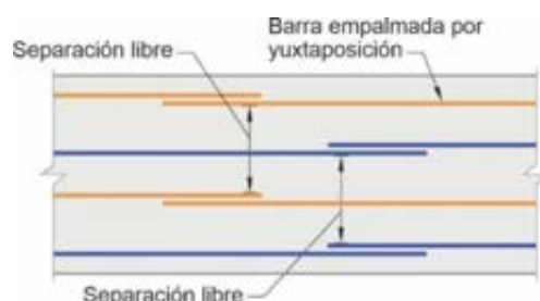
Figura C 25.5.2.1. Separación libre de las barras empalmadas por yuxtaposición para determinar \ell_d de los empalmes escalonados.
