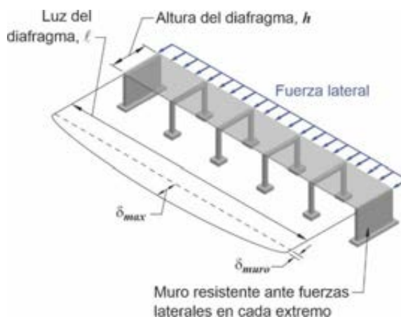
Figura C 12.4.2.3a. Ejemplo de diafragma que podría no ser considerado como rígido en su plano.
