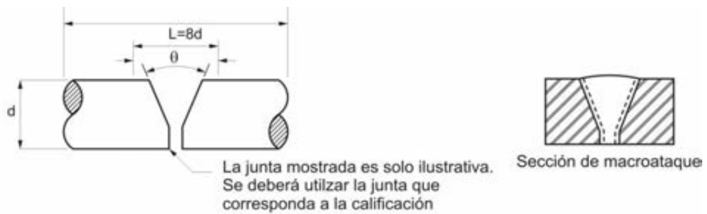
(A) Unión a tope directa - Junta de penetración completa (JPC)
