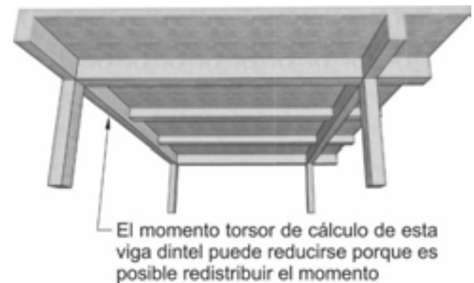
Figura C 22.7.3b. Torsión de compatibilidad, el momento torsor de cálculo puede ser reducido (artículo 22.7.3.2).
